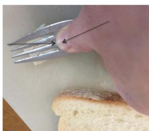
Um garfo pode ser aplicado à amostra de alimento para observar seu comportamento quando a pressão é aplicada. A pressão aplicada à amostra de alimento foi quantificada pela avaliação da pressão necessária para tornar a unha do polegar visivelmente branca, como demonstrado pela seta na imagem à esquerda.
