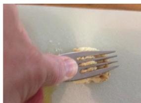
Para a avaliação usando o Teste de Pressão de Garfo, recomenda-se que o garfo seja pressionado sobre a amostra de alimento colocando o polegar sobre a base do garfo (logo acima dos dentes) até que o branqueamento seja observado, como mostrado na imagem à esquerda. É sabido que garfos não são usados/estão prontamente disponíveis em algumas partes do mundo. Assim, a pressão aplicada usando a base de uma colher de chá pode fornecer uma alternativa útil.
